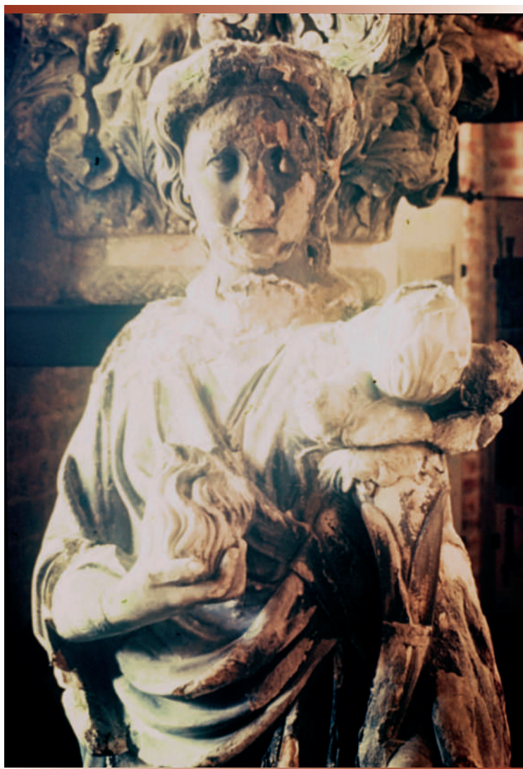
Figura 1 - Bartolomeo Bon, statua della Carità della Porta della Carta di Palazzo Ducale di Venezia, prima del restauro. È in marmo di Carrara fortemente deteriorato per effetto della solfatazione da inquinamento atmosferico, responsabile della formazione delle croste nere visibili nelle parti protette dal dilavamento meteorico.
